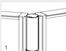
**1** Winkelvariable Verbindungssäule für bis zu 5 Elemente gleichzeitig.
