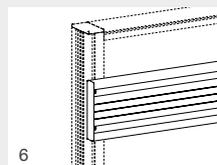
**6** Nachrüstbare Funktionsleiste (max. Belastung 5 kg) stufenlos höhenverstellbar im Funktionskanal.
