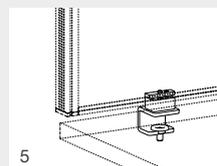
**5** Tischklemme zur Befestigung des Sichtschutzelementes hinter der Tischplatte, links und rechts im Funktionskanal einsetzbar.
